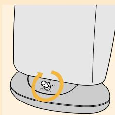
**3** Accendete l'apparecchio ruotando il commutatore in senso orario.
